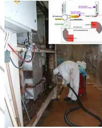
© CO<sub>2</sub>-Verpuffung an Kuchenbackstraße nach Servicearbeiten am Gasbrenner
